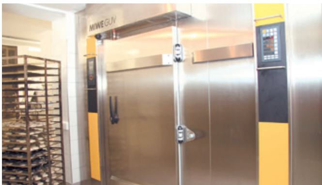
GUV (слева) оснащен системой управления TC, а TLK – системой управления с жестко-заданными программами.
