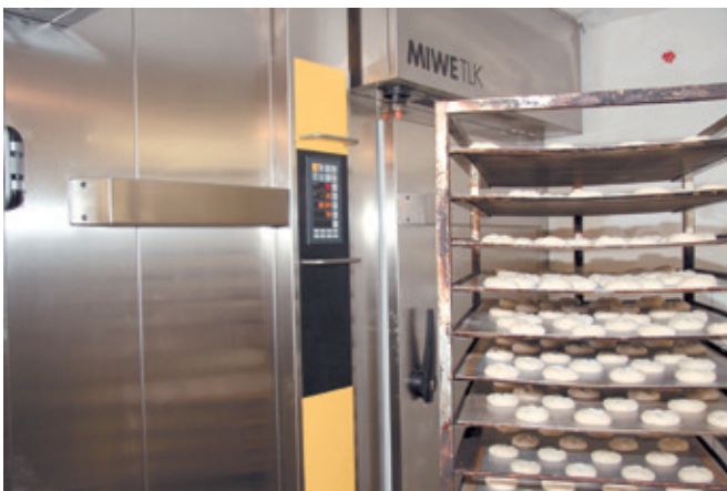
Для TLK вполне достаточно системы управления с жестко заданными программами, поскольку изменения в программах здесь практически не выполняются.
