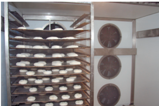
В TLK встроено устройство быстрого охлаждения для двух стеллажных тележек.
