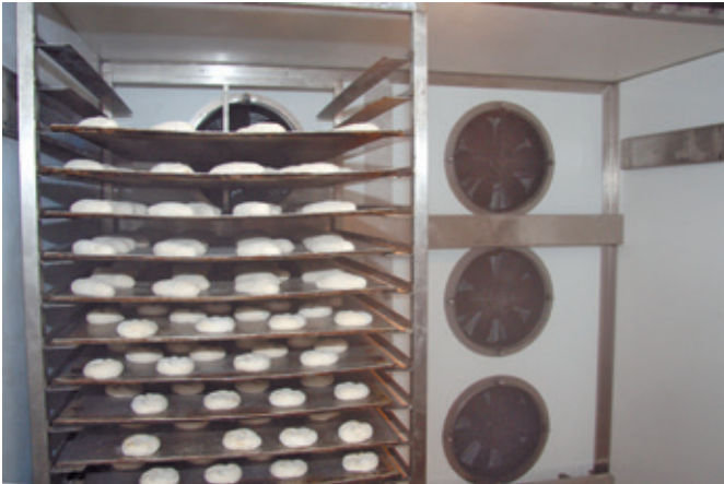
Im TLK integriert ist ein Schnellabkühler für zwei Stikkenwagen.
