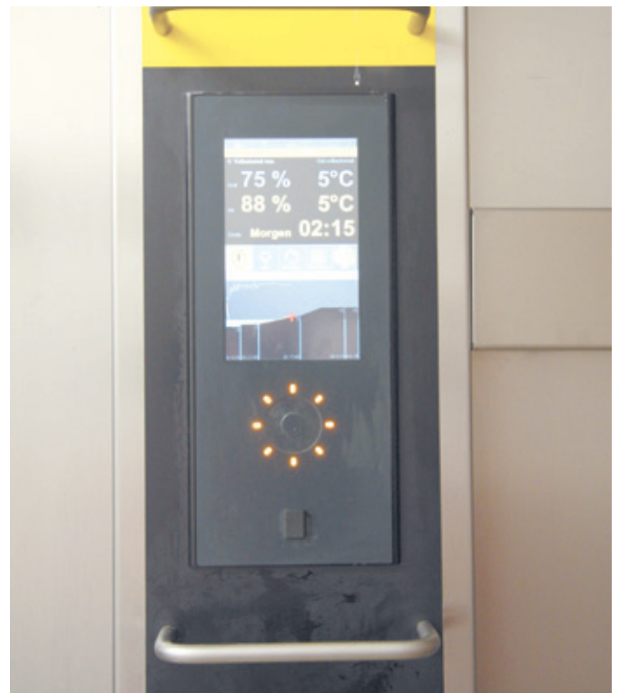
Die TC-Steuerung am GVA.
