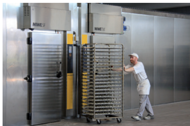
L'ensemble des pâtons destinés à être congelés passent par le sas de surgélation, ce qui améliore nettement leur qualité.
