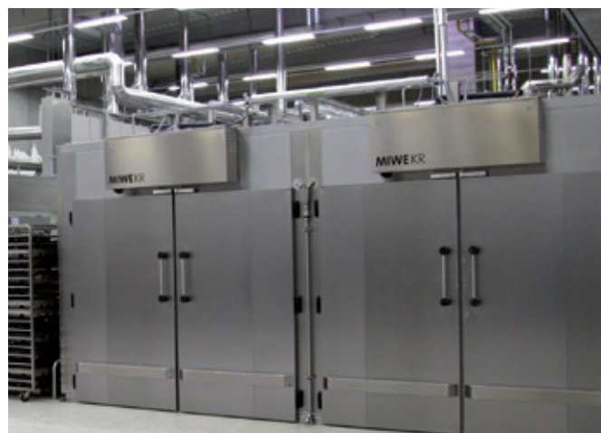
Pour la fermentation, des espaces de réfrigération MIWE sont disponibles. Même lors d'un été chaud, la température peut être maintenue avec précision, ce qui permet de garantir une qualité reproductible.
