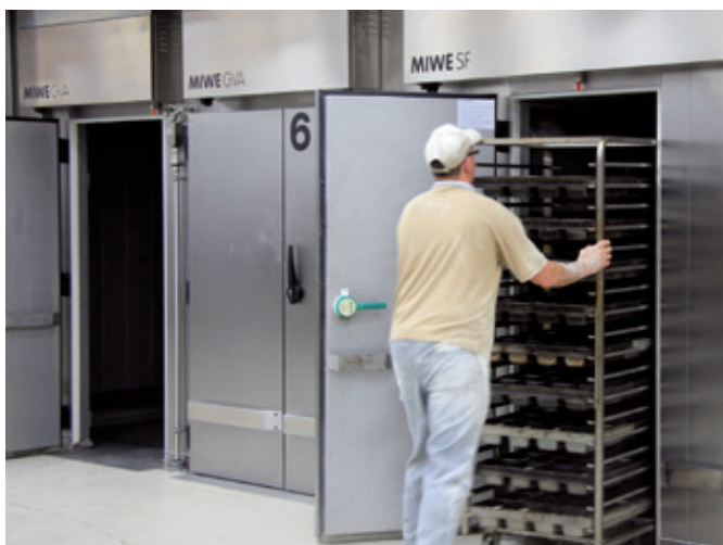
Les surgélateurs rapides sont raccordés à leur propre machine frigorifique pour pouvoir mettre rapidement à disposition la grande puissance frigorifique requise.
