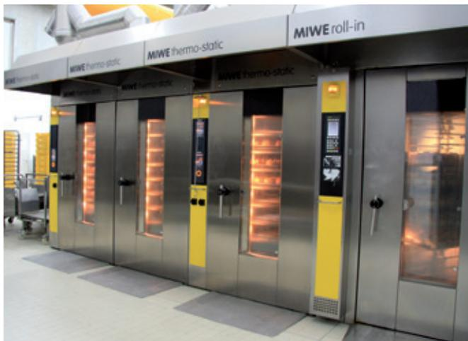
Ротационные печи с термомасляным нагревом и стеллажные печи предусмотрены для загрузки с роликовой системой.
