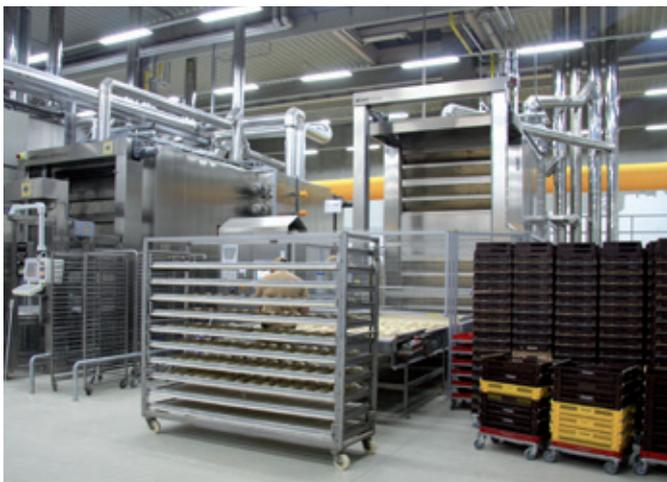
Рядом с конвейерной печью туннельного типа с термомасляным нагревом размещена печь с циркуляцией горячего воздуха MIWE ideal M. Обе печи оснащены системой загрузки.
