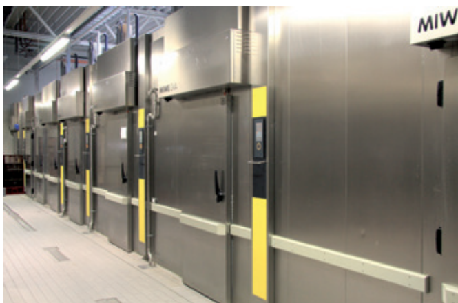
Les cellules de congélation et les installations de fermentation entièrement automatiques sont réunies sous forme de bloc d'installations dans la boulangerie.
