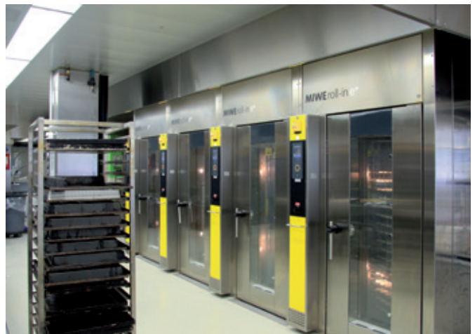
Les 11 roll-in e+ forment des blocs de cuisson au rez-de-chaussée du site de production.
