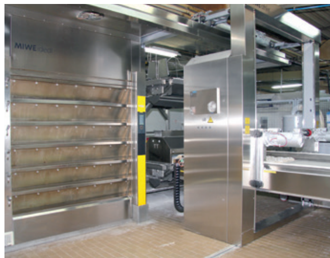
Общий вид загрузочного агрегата MIWE athlet перед MIWE ideal.
