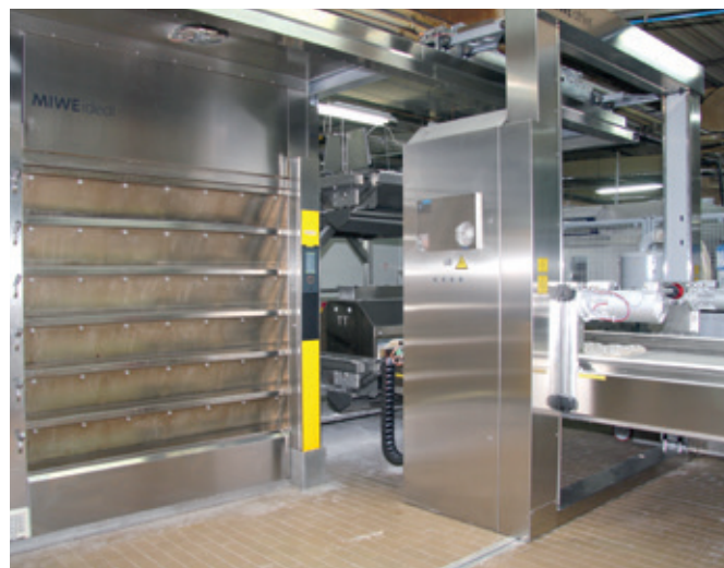
L'installation d'enfournement MIWE athlet installée devant le MIWE ideal.
