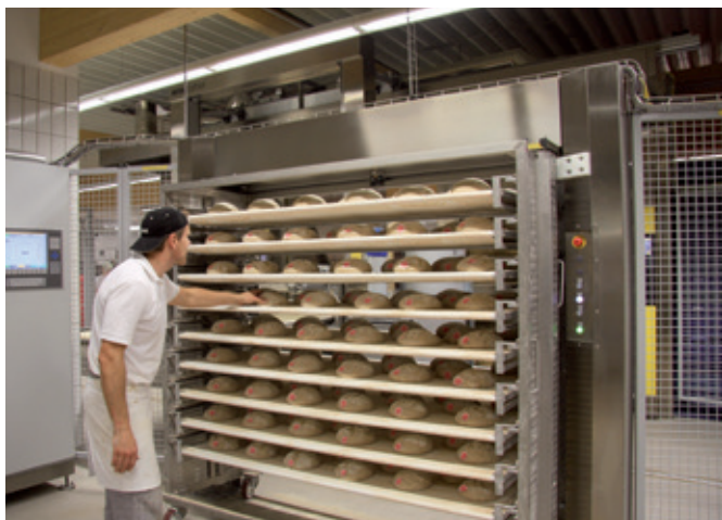
На передаточной станции система загрузки автоматически забирает хлеб.
