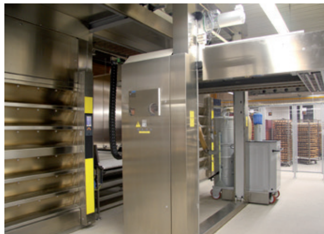
Загрузка двух печей MIWE ideal выполняется системой MIWE athlet. Между ними расположен отводящий транспортер для отправки продукции.
