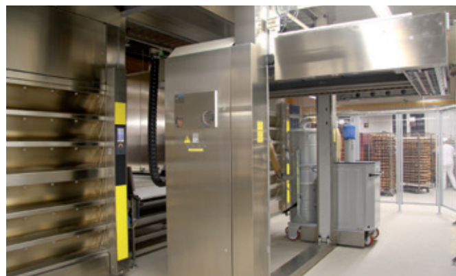
Les deux MIWE ideal sont enfournés par un MIWE athlet. Au milieu se situe la bande de sortie pour l'expédition.
