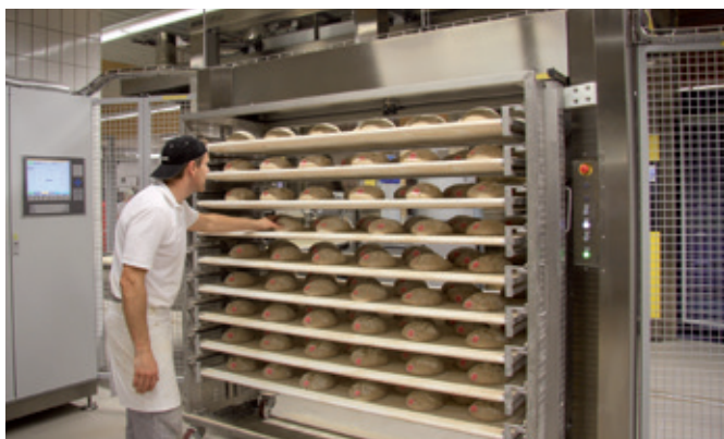
Le chargeur récupère automatiquement les miches de pains à la station de transfert.
