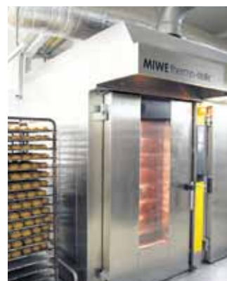
Backen wie auf Etage, beschicken wie beim Stikken: Der Thermoölbackofen MIWE thermo-static vereint die Vorteile beider Welten.
