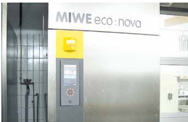
Auch die Wärmerückgewinnungsanlage MIWE eco:nova wird mittels Touch Control MIWE TC gesteuert.
