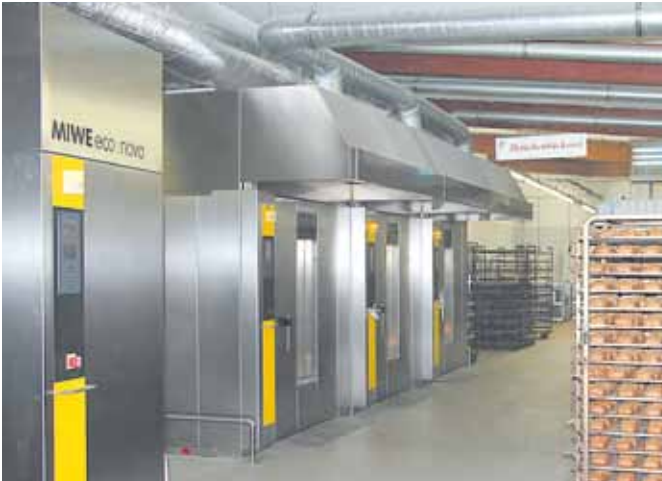
Gleichbleibendes Bedienkonzept: drei Doppelstikkenbacköfen und die neue Wärmerückgewinnungsanlage MIWE eco:nova.
