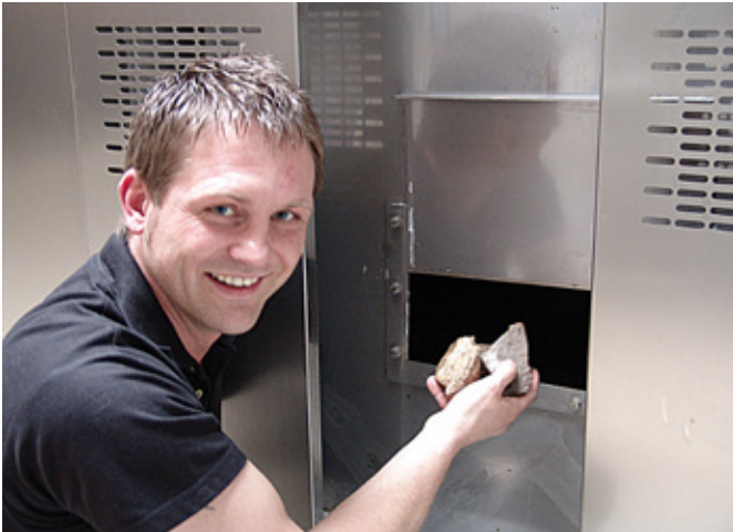
Дымовой газ очищается в eco:nova от двуокиси серы. Кристиан Браун из компании Miwe показывает известняк, используемый для нейтрализации.
