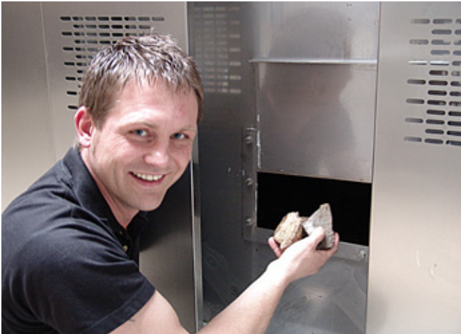
Dans l'eco:nova, les fumées sont débarrassées du dioxyde de soufre. Christian Braun de MIWE montre les pierres calcaires utilisées pour la neutralisation.
