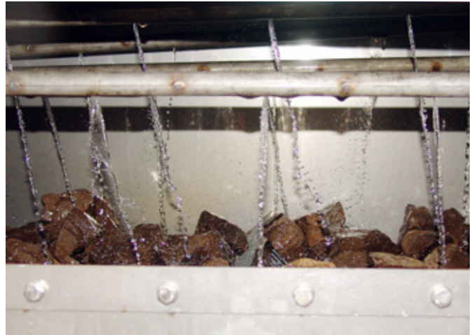
Lavage des fumées dans la MIWE eco:nova.
