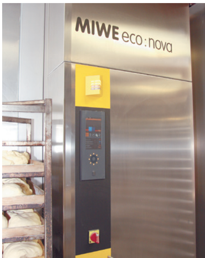
L'installation MIWE eco : nova est pilotée et surveillée avec une commande TC.
