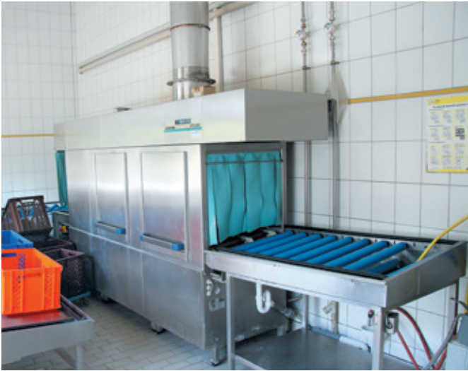
La machine à laver les caisses est le plus gros consommateur d'eau chaude chez Maxl Bäck.
