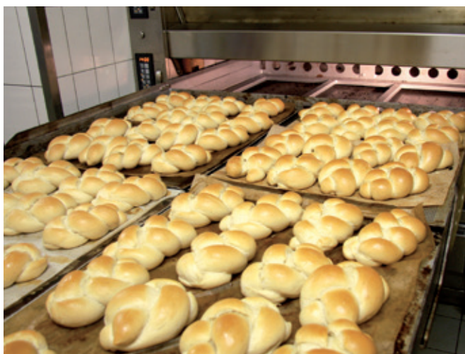
Выдвижные поды позволяют легко выполнять посадку изделий в печь и их выемку из печи.
