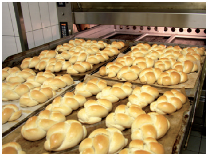
Die Auszugsherde erlauben die leichte Befüllung und Entnahme der Öfen.
