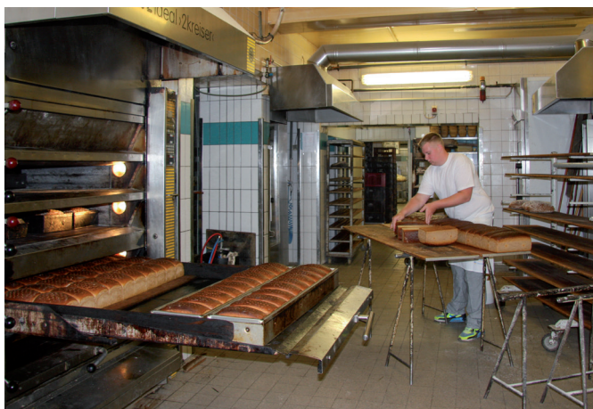
Большие пекарные формы, например, для Падерборнского хлеба устанавливаются в MIWE ideal на выдвижные поды.
