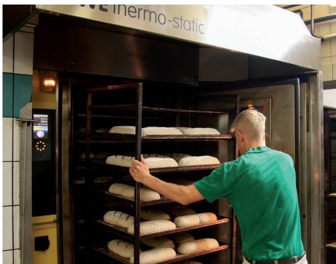
На месте прежней ярусной печи теперь стоит MIWE thermo-static с непосредственно интегрированным центральным котлоагрегатом.
