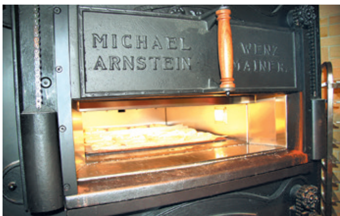
Vue dans une des deux chambres de cuisson.
