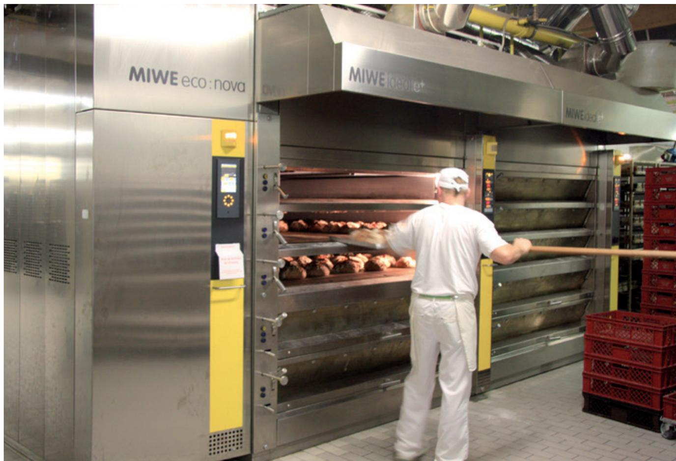
Две печи MIWE ideal e+ используются преимущественно для выпечки хлеба. Рядом находится MIWE eco:nova, к которой дополнительно отводится отработанное тепло центрального котлоагрегата.
