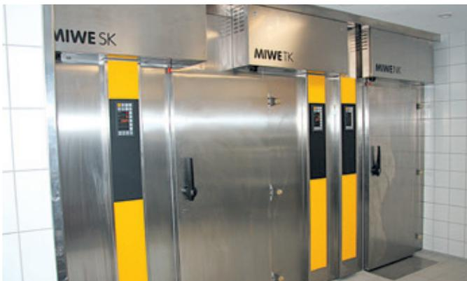
Неотъемлемой частью пекарни сегодня является холодильное оборудование. Вот поэтому в распоряжение учеников предоставлены камеры охлаждения для изделий со сливками (MIWE SK), камеры глубокой заморозки (MIWE TK) и камеры обычной заморозки (MIWE NK).
