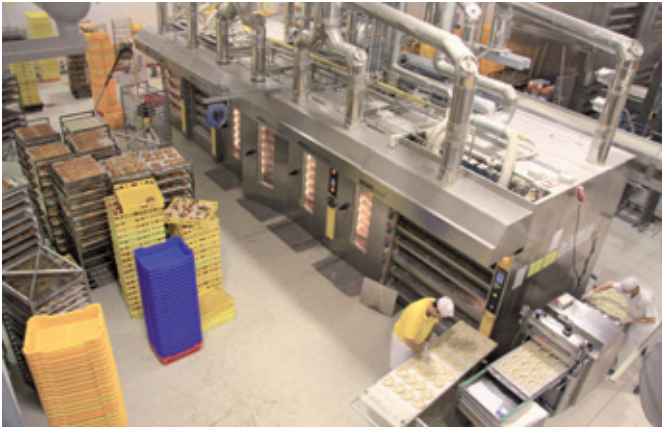
Vue sur les fours: fours à chariot fixe (au centre) et fours à sole (à gauche et à droite).
