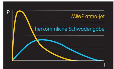
Entscheidend ist die Schwadenmenge in den ersten Sekunden; so kann ein Maximum an Schwaden kondensieren, bevor er überhitzt. Wie die Grafik zeigt, stellt MIWE atmo-jet den Schwaden mit rund 2,5-fachem Druck deutlich schneller zur Verfügung.
