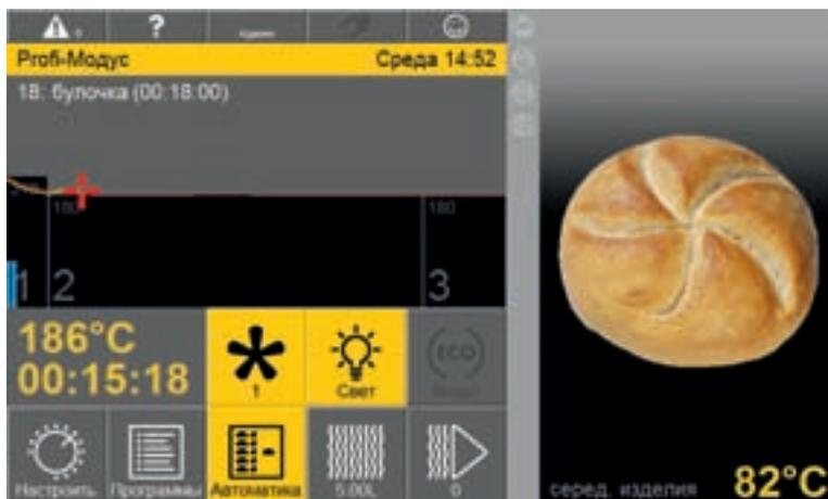
... и запомнит ее как новую заданную кривую (красного цвета). Теперь эта кривая будет активироваться при каждом нажатии клавиши «Автоматическое регулирование расхода для MIWE flexbake».
