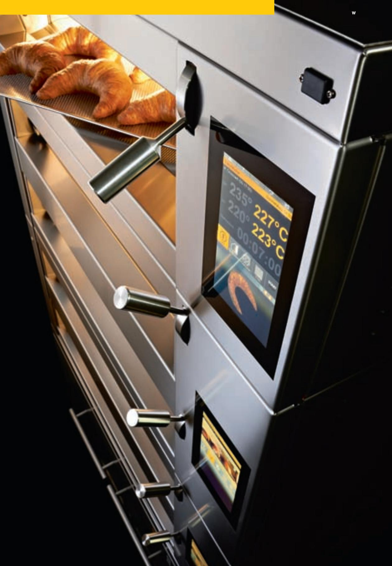
Опытные пользователи MIWE без проблем узнают в ней Touch Control MIWE TC, которой оборудованы и другие приборы MIWE. Конечно, в этой модели система оснащена идеальной плоской стеклянной панелью, которая не только великолепно выглядит, но и прекрасно поддается очистке, а также новым 7-дюймовым дисплеем высокой контрастности с прекрасно читаемым текстом даже на большом расстоянии.
