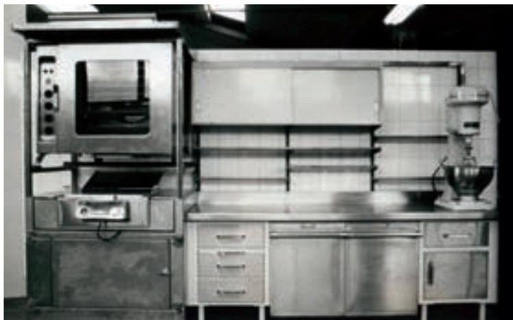
воплощением и, одновременно, прообразом современных станций магазинной выпечки, разработанным еще в 1960-х годах, стала «рабочая стенка MIWE», – модульная концепция, в центре которой находилась магазинная хлебопекарная печь.
