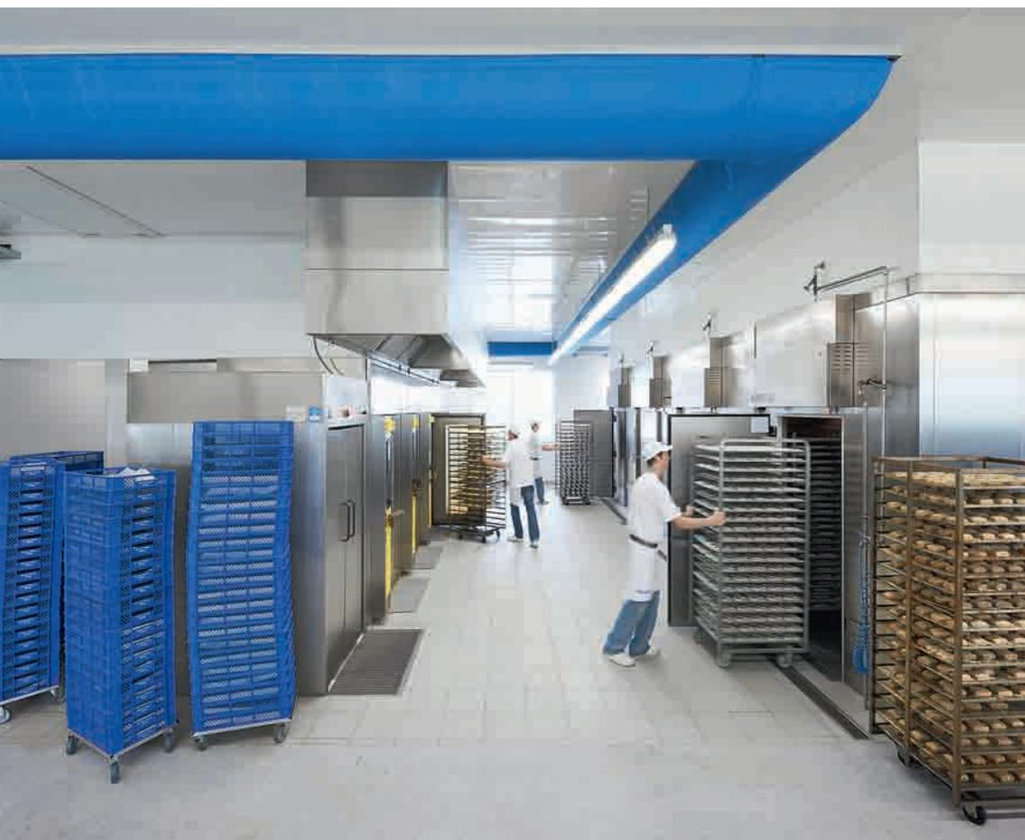
Непревзойденный технологический процесс: 6 MIWE roll-in e+ с расположенными напротив шкафами автоматической расстойки. Они выполнены в виде проходной единицы – позади расположены шкаф шоковой заморозки и камера глубокой заморозки
