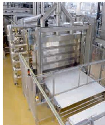
Сердце суперсовременного производства: 6 модульных этажных печей MIWE ideal M по 3 пода автоматически обслуживаются посредством MIWE athlet XXL. Посадочный транспортер и отгрузчик расстойных тележек не требуются как и регенерация тепла с MIWE есо:пова, к которой, в данном случае, подключаются другие ротационные печи
