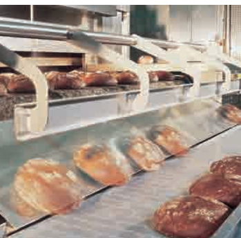
Передача с каменной на транспортировочную ленту.
