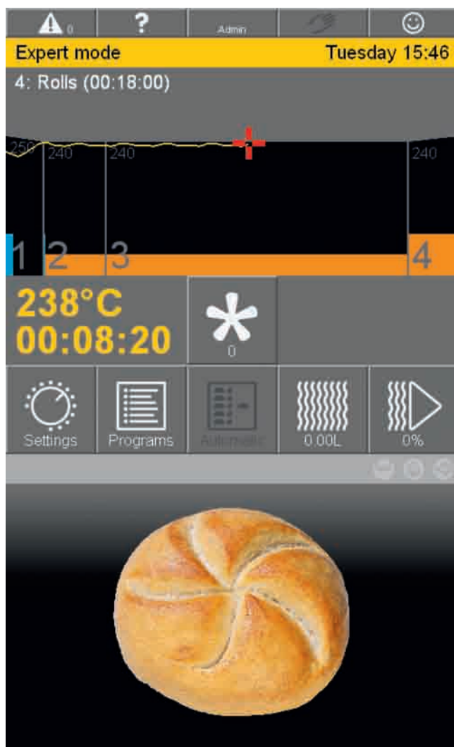
Наглядно: Оранжевая линия обозначает работу двухступенчатой турбосистемы – голубая линия показывает пароувлажнение.
