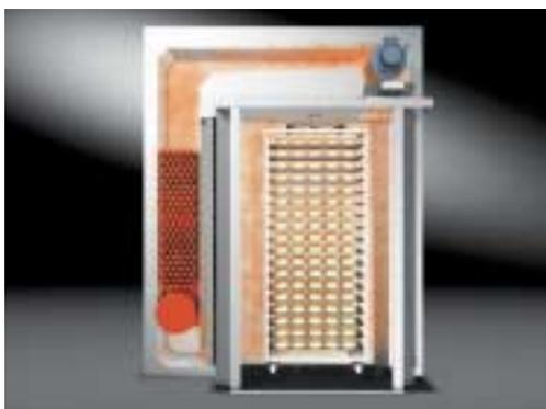
При увлажнении решётка защищает пекарную камеру: так происходит насыщенное, равномерное увлажнение с пониженным расходом воды.
