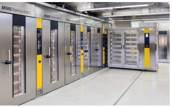
Mit dem Beschickungssystem MIWE assist lässt sich eine ganze Batterie von Thermoöl-Wagenöfen – optional sogar mit Steinplattengestellen – kraftsparend beschicken à sieben bis zehn Bleche in drei Blechmaßen. Zum Abbacken der gesamten Produktpalette geeignet, vom schweren Roggenbrot bis hin zu Weizenkleingebäck.
