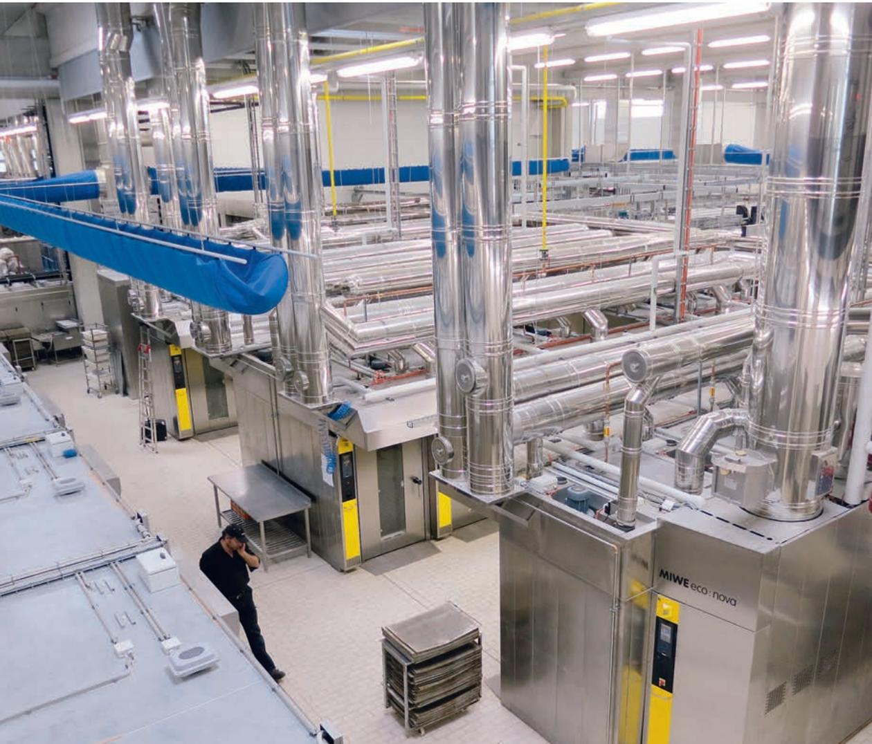
entwickelt (beispielsweise der MIWE roll-in e+, der vermutlich sparsamste Stikkenofen der Welt) und andererseits Systemkomponenten und -verbunde wie die MIWE eco:nova in den Markt gebracht, die ihrerseits mit maximalem Wirkungsgrad die technisch nicht vermeidbare Abwärme der Backprozesse so weit als irgend möglich zurückgewinnen und die so
