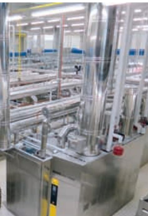
Rückgewinnungslösung nur die MIWE eco:nova in Frage. Zwei davon (vom größten verfügbaren Typ 960) greifen nun die Abwärme der gesamten Stikkenofenbatterie ab. Deswegen kommt die ganze Anlage auch mit gerade einmal zwei Kaminen für Rauchgas und Schwaden aus – ein erheblicher Kostenvorteil für den Bäcker.
