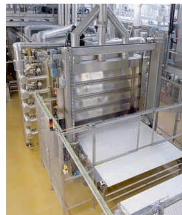
Herzstück einer hochmodernen Produktion: 6 modulare Etagenbacköfen MIWE ideal M à 3 Herde werden vom MIWE athlet XXL vollautomatisch bedient. Aufsetzband und Gärwagenentladeeinheit fehlen ebensowenig wie die Wärmerückgewinnung mit der MIWE eco:nova, an die in diesem Fall noch weitere Stikkenöfen angeschlossen sind.
