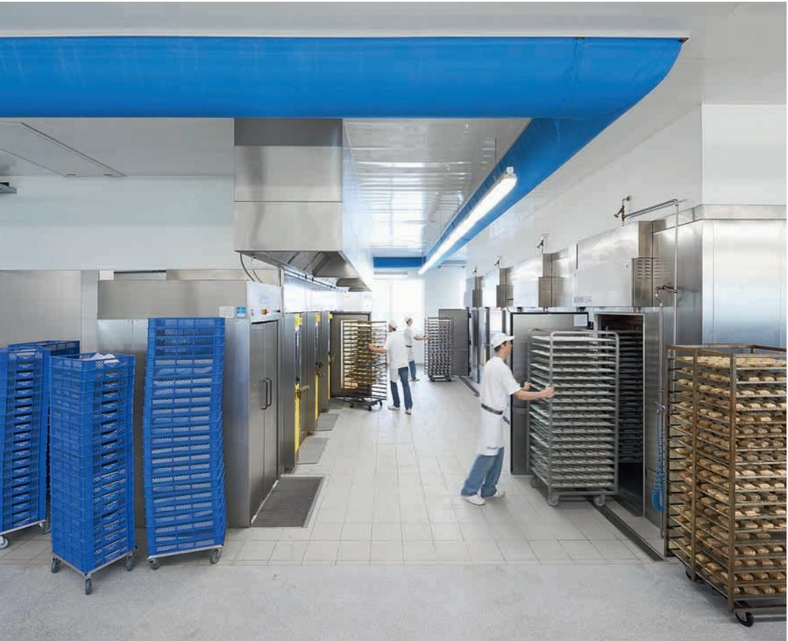
**Perfekter Materialfluss:** 6 MIWE roll-in e+ mit gegenüberliegenden Gärvollautomaten. Diese sind als Durchschiebeeinheit ausgelegt – dahinter befinden sich Schockfroster und Tiefkühlager.
