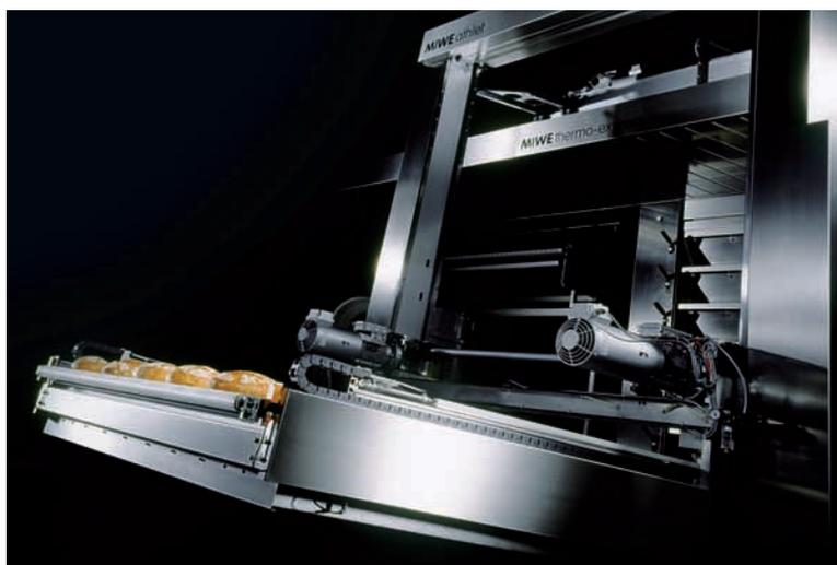
Thermoölbeheizte Etagenbacköfen wie der MIWE thermo-express (hier in Kombination mit vollautomatischer Beschickungstechnik) verhalten sich beim Wärmeübergang ähnlich wie Rauchgasumwälzer, bieten darüber hinaus aber alle Vorteile der Thermoöltechnik, wie „sanfte“ Hitze, zentrale Heizkessel u. v. m.
