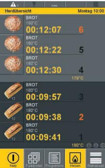
Oben: Herdübersicht eines Etagenbackofens auf der MIWE TC. Bei diskontinuierlicher Fertigung liegen Verantwortung und Kontrolle in der Hand des Bäckers.
