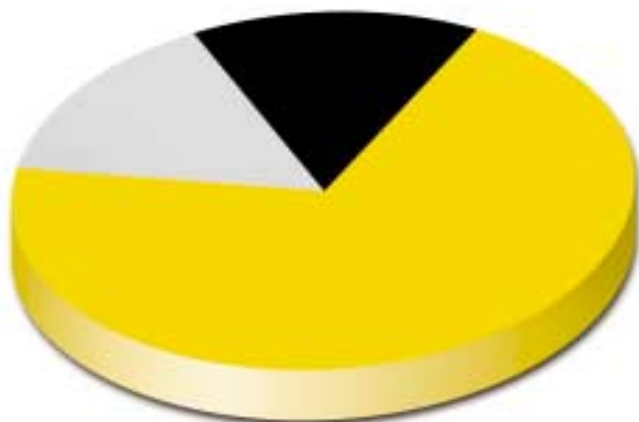
Energieverbrauch beim Backen: Rauchgas / Schwaden ■ Operative Verluste ■ Eigentliche Backenergie ■
