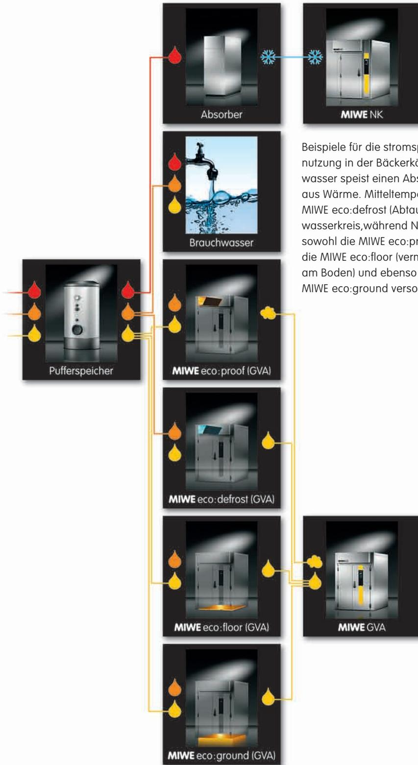
Beispiele für die stromsparende Warmwassernutzung in der Bäckerkälte. Hochtemperaturwasser speist einen Absorber, erzeugt also Kälte aus Wärme. Mitteltemperaturwasser fließt in die MIWE eco:defrost (Abtauung) sowie in den Brauchwasserkreis, während Niedertemperaturwasser sowohl die MIWE eco:proof (Gärwärme) als auch die MIWE eco:floor (vermeidet Kondensatbildung am Boden) und ebenso den Unterfrierschutz MIWE eco:ground versorgt.
