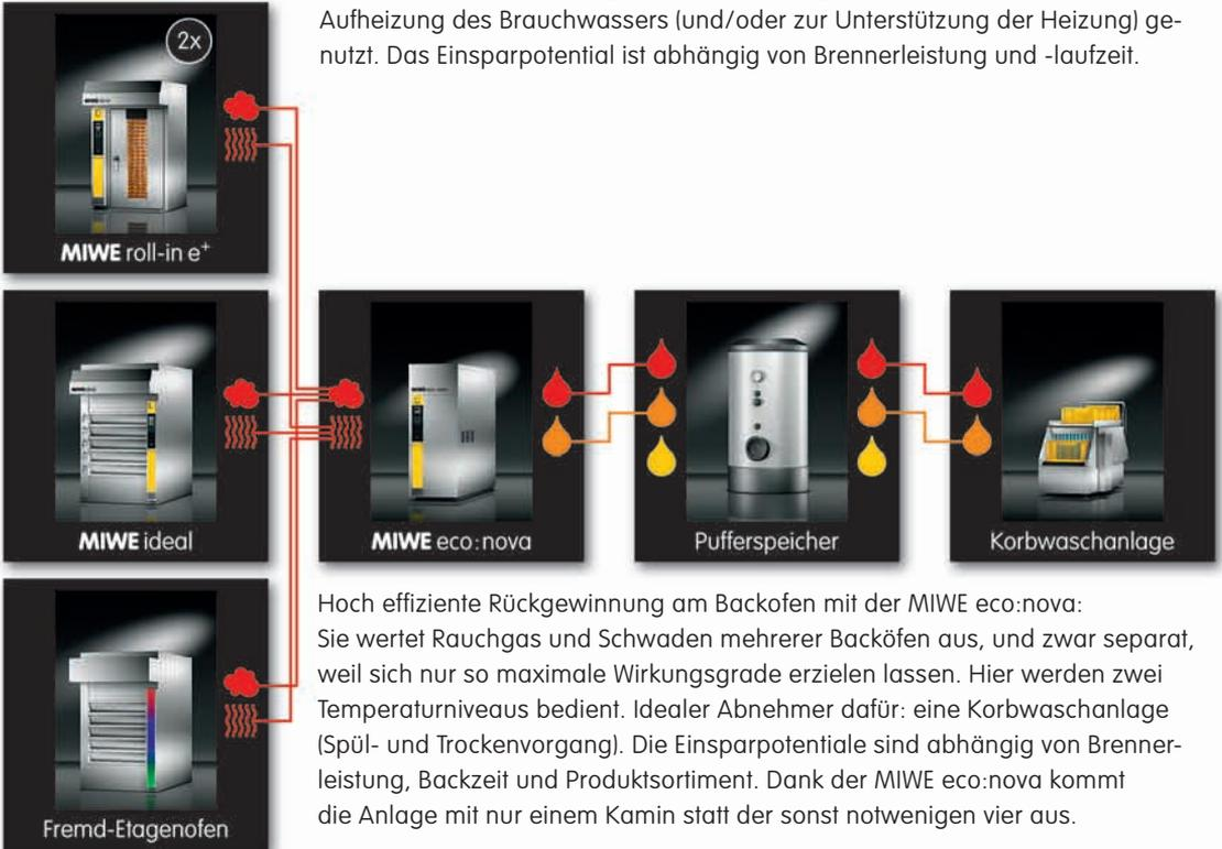
Hoch effiziente Rückgewinnung am Backofen mit der MIWE eco:nova: Sie wertet Rauchgas und Schwaden mehrerer Backöfen aus, und zwar separat, weil sich nur so maximale Wirkungsgrade erzielen lassen. Hier werden zwei Temperaturniveaus bedient. Idealer Abnehmer dafür: eine Korbwaschanlage (Spül- und Trockenvorgang). Die Einsparpotentiale sind abhängig von Brennerleistung, Backzeit und Produktsortiment. Dank der MIWE eco:nova kommt die Anlage mit nur einem Kamin statt der sonst notwendigen vier aus.
