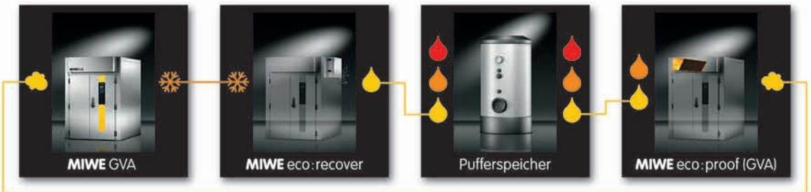
Der sogenannte „kleine Kältekreislauf“: Die Abwärme aus der Kompressionskältemaschine des Gärvollautomaten MIWE GVA wird über eine MIWE eco:recover in Warmwasser abgetauscht, das im gleichen Gärvollautomaten als Gärheizung (sanfte Charakteristik!) genutzt wird. Das spart teure elektrische Energie.
