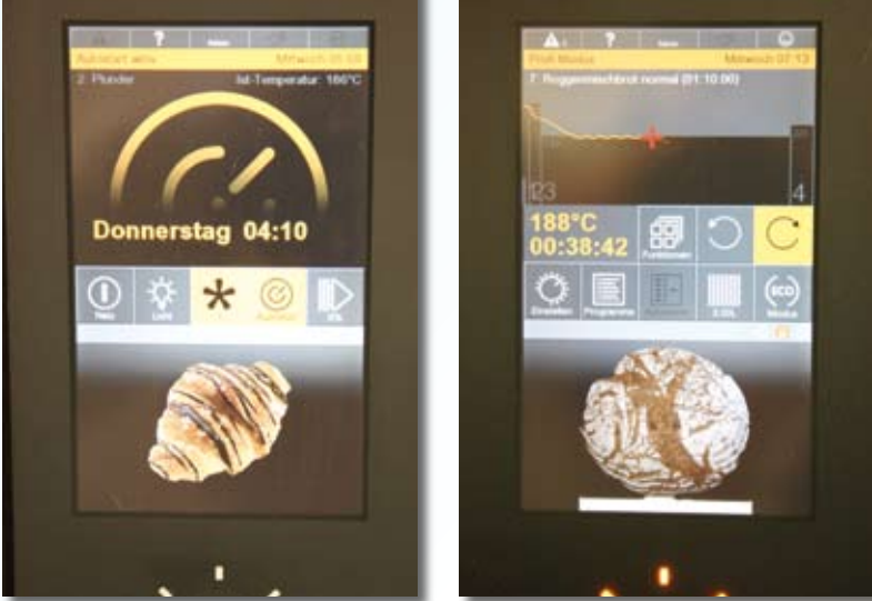
Die Touch Control-Steuerung von Miwe ist intuitiv bedienbar und bietet nützliche Sonderfunktionen, wie die Ansteuerung der aircontrol, Frostlingsbacken und eine Mengenautomatik.
