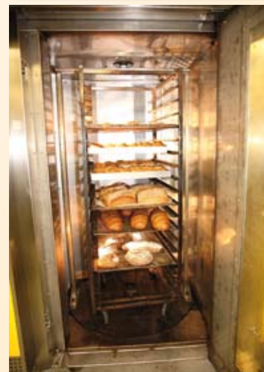
Soweit es möglich ist, backt Müssig verschiedene Produkte in einem Ofen. Damit das funktioniert, wird Brot z.B. vorgebacken oder Kleingebäck erst zeitversetzt dazu geschoben.
