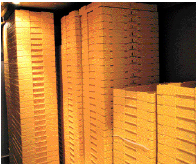
Im Gegensatz zur Lagerung auf Blechen oder normalen Dielen können mit den Spezialdielen viel mehr Teiglinge auf gleichen Raum gelagert werden.
