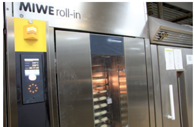
De besturing van de MIWE roll-in oven is ervoor gebouwd en dus op een afstand van de hete bakkamer.
