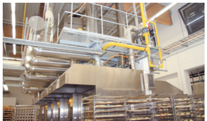
Die MIWE eco:nova ist auf die Stikkenöfen gebaut.
