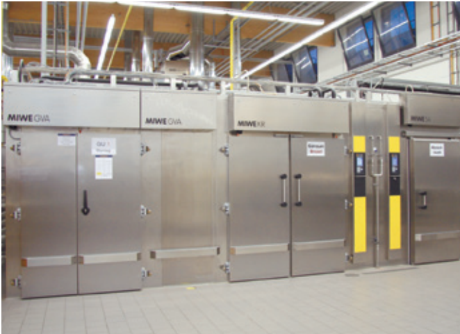
Die in der Halle stehenden Gärvollautomaten und Gärräume sind von zwei Seiten begehbar – dies erleichtert wesentlich die Arbeit.
