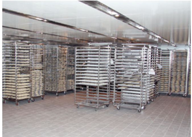
Blick in die Teiglingskonservierungsanlage.
