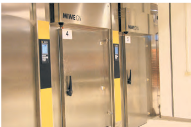
Ein großer Teil von dem was in der Backstube gebacken wird, führt Gellertstadt Backwaren über Gärvollautomaten bzw. Gärverzögerer.
