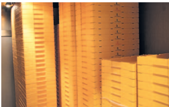
Contrairement au stockage sur des plaques ou sur des planchers conventionnels, on peut stocker beaucoup plus de pâtons dans un même espace à l'aide des planchers spéciaux.
